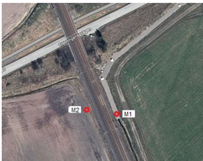
Foto 5: Dubbelspår vid Trönningenäs där ljudmätningar utförts både väster och öster om spåren. Mätpunkt M1 vid nedspår och mätpunkt M2 vid uppspår är markerade med röda cirklar
