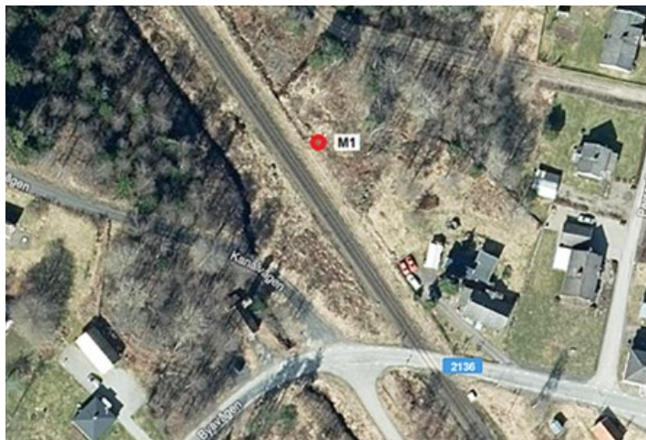
Foto 8: Enkelspår Hökön, ljudmätningar av tågpassager utförda nordost om spåret. Mätpunkten M1 är markerad med en röd cirkel
