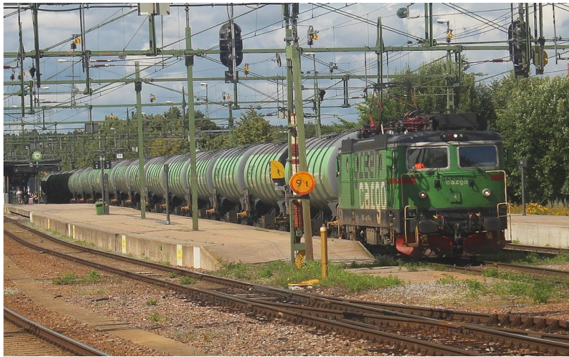
Foto 10. Ett Rd2 ellök och flygbränsletankvagnar med kompositbromsblock
